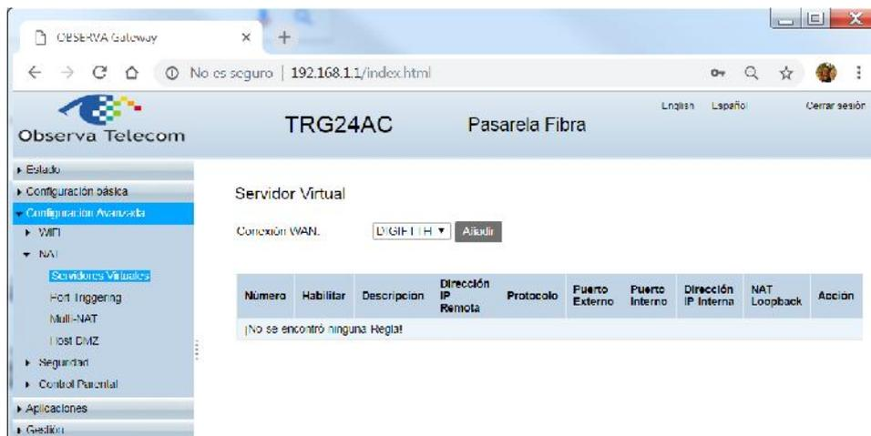
Un Servidor Virtual puede utilizarse para configurar servicios públicos en su red local, como un servidor HTTP, FTP, DNS, POP3/SMTP y Telnet. Servicios diferentes utilizan diferentes puertos de servicio. El puerto 80 se utiliza para servicio HTTP, el puerto 21 se utiliza en servicio FTP, el puerto 25 se utiliza para SMTP, el puerto 110 se utiliza para servicio POP3... Por favor, verifique el número de puerto del servicio antes de la configuración. P.ej: Wan IP : 183.39.154.141
